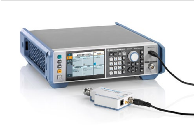
通过 USB 连接 R&S®NRP 功率探头的 R&S®SMB100B。
